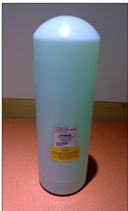
Рис. 17. Флакон с фантомом Siemens 5300 мл (P/N: 10606530 K2305)
