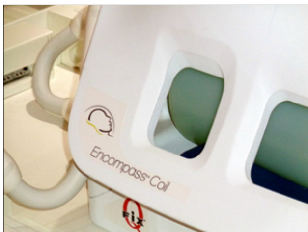
Рис. 19. Размещение флакона с фантомом внутри катушек
