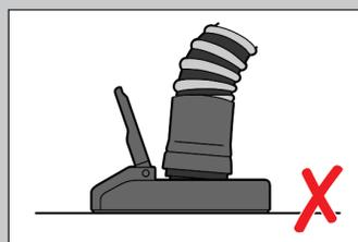
**! ПРИМЕЧАНИЕ !** После включения источника подачи воздуха AirSource дождитесь полного накачивания AirBearing, прежде чем приступать к перемещению.
