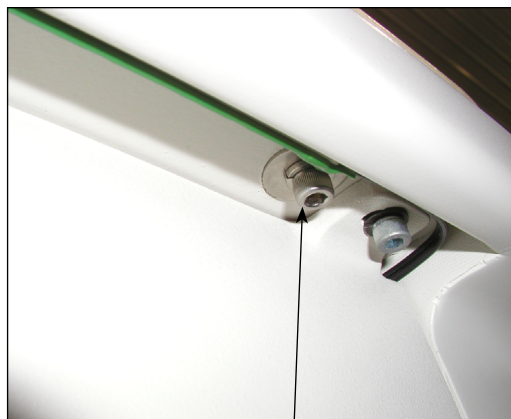
图 23 松开两侧螺钉, 从左向右调整。
