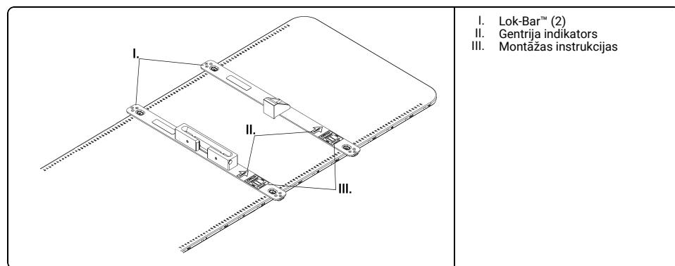
2. Novietojiet Varian MPC IsoCal imitācijas paliktni uz katra Lok-Bar™.
