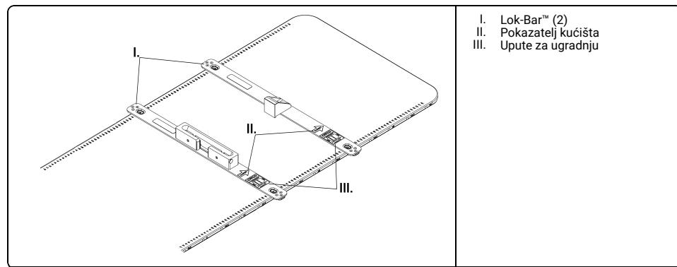
2. Postavite nosač za fantom Varian MPC IsoCal na svaki element Lok-Bar™.
