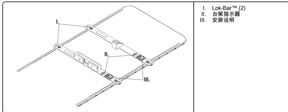
2. 将 Varian MPC IsoCal 仿真底座安装在各个 Lok-Bar™ 上。
