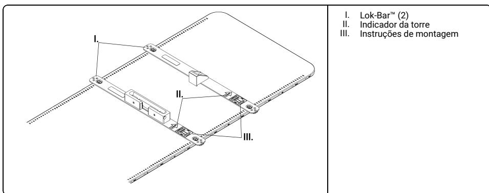
2. Coloque o suporte Phantom Varian MPC IsoCal em cada Lok-Bar™.
