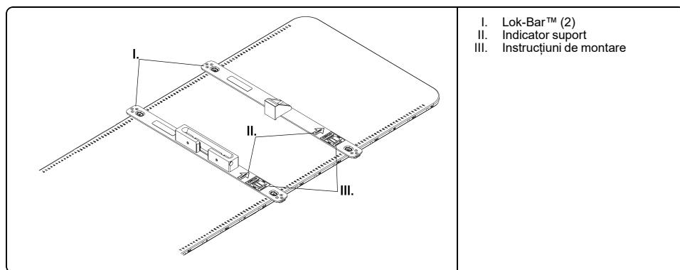
2. Așezați montura fantomă Varian MPC IsoCal pe fiecare Lok-Bar™.
