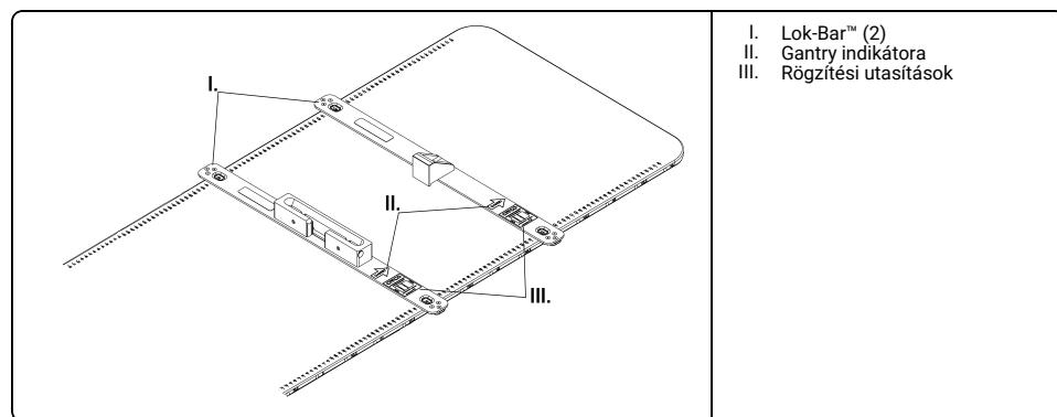
2. Helyezze a(z) Varian MPC IsoCal mérőphantomtartót mindegyik Lok-Bar™ elemre.
