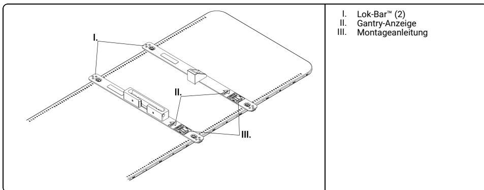
2. Die Varian MPC IsoCal-Phantomhalterung auf jedes Lok-Bar™ aufsetzen.
