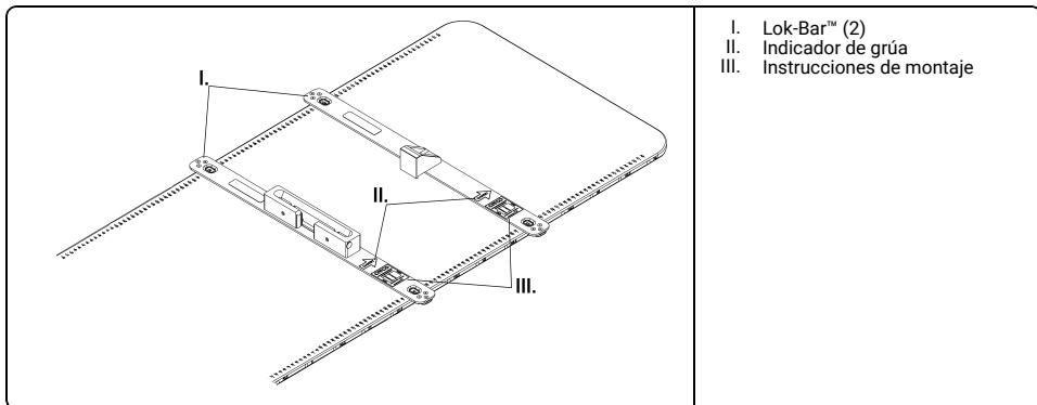
2. Colocar la montura simulada Varian MPC IsoCal en cada Lok-Bar™.
