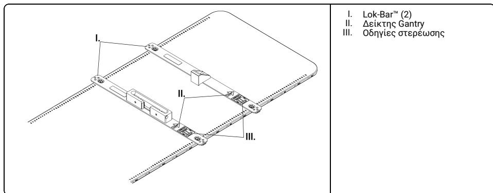
2. Τοποθετήστε τη βάση στήριξης του Varian MPC IsoCal phantom σε κάθε μπάρα Lok-Bar™.
