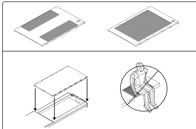
2. Kontrollera att riktningen är korrekt och att den är ordentligt fastsatt.
