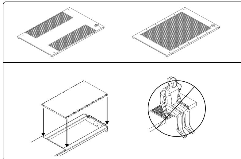
2. Stellen Sie sicher, dass der Rahmen richtig orientiert und sicher angebracht ist.
