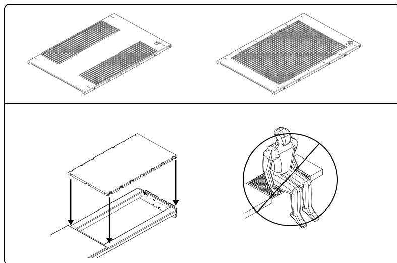
2. Accertarsi che l'orientamento sia corretto e saldamente fissato.
